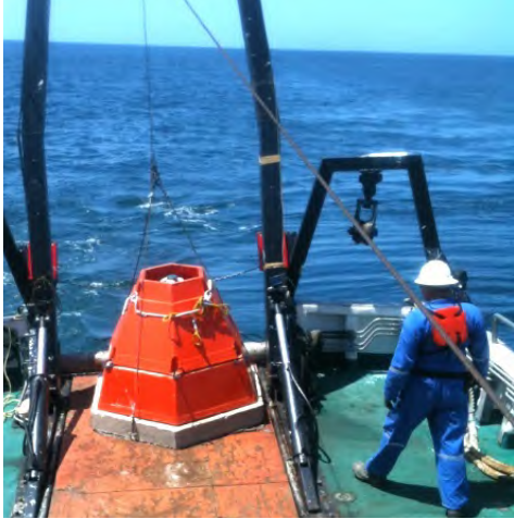
ADCP en base antirrastras listo para ser lanzado
