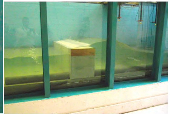
■ Modelo físico. Rompeolas de Cajón. INHA Barcelona. España
