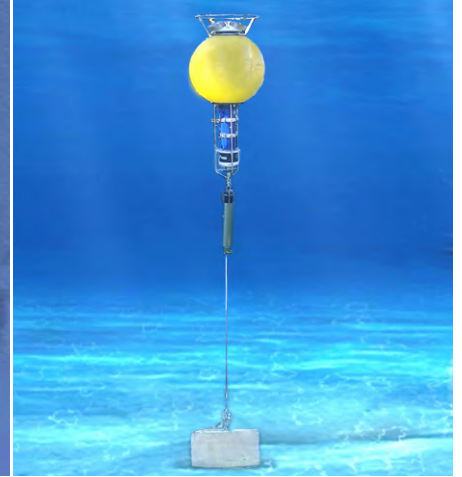
ADCPs instalados en boya a 10m sobre el fondo
